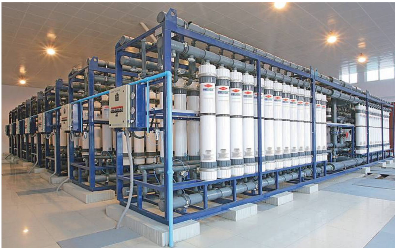
Figura 7. Detalle de instalación usando módulos DOW™ UF 2860
